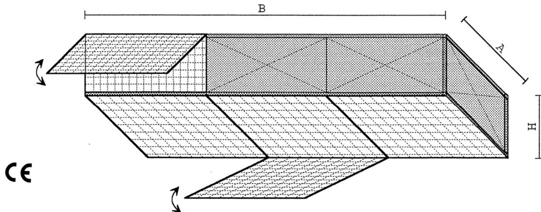
Abbildung zeigt einen HAVAU-Zuluftdeckenfilterkasten mit 3 m<sup>2</sup> Filterfläche nach unten und einem zusätzlich eingebauten Filtrahmen mit Luftaustritt nach vorne.
