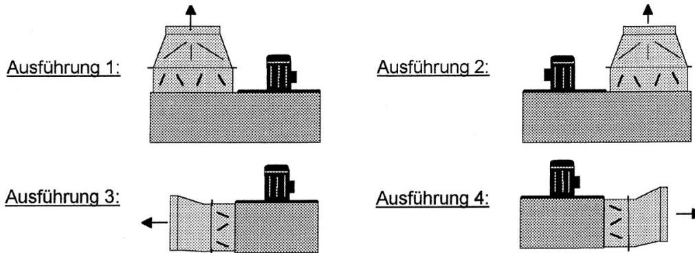
Das jeweilige Aggregat wird standardmäßig mittig auf der Absaugwand montiert, kann aber auf Wunsch mehr oder weniger links bzw. rechts sowie seitlich oder hinten angeordnet werden. Auf Wunsch kann das Aggregat auch so gefertigt werden, dass es separat platziert und durch eine Saugleitung mit der Spritzwand verbunden wird.
