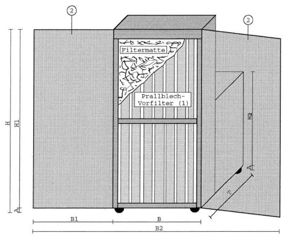
Abbildung zeigt Grundgerät mit folgendem Zubehör: - Prallblech-Labyrinth-Vorfilter (1) Seitenteile (schwenkbar) (2)
